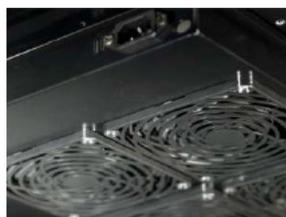
Predisposizione a tetto per impianto di ventilazione a 2 e 4 ventole.
